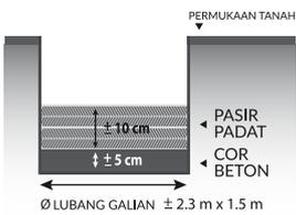
Siapkan lubang dengan diameter lebih besar dari LUCKY SEPTICTANK. Kedalamannya disesuaikan dengan saluran pipa toilet/wc. Sebagai pondasi, cor beton ± 5 cm dan masukan pasir yang dipadatkan, dengan ketebalan ± 10 cm.
